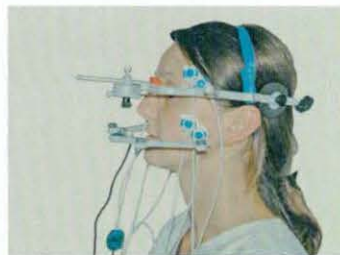
Abb. 1: Untersuchungsaufbau. Proband mit Snap-Elektroden für das sEMG des m. masseter und des m. temporalis anterior und ultraschallbasiertem Registrierersystem.
