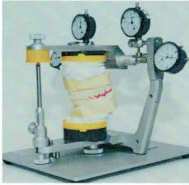
Abbildung 4 Messartikulator: CONDY-METER III 400 (SAM Präzisionstechnik, Gauting bei München/Deutschland) mit eingesetztem Modellpaar. Hier: Ein HIKP-Modellpaar mit genullten Messuhren.
