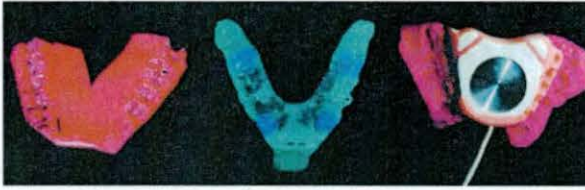
Abbildung 5 Links: Wachsplatte. Mitte: Kunststoffplatte mit Detailpaste. Rechts: Unterkiefer-Sensorträger mit Messsensor und Silikonverschlüsselung.
